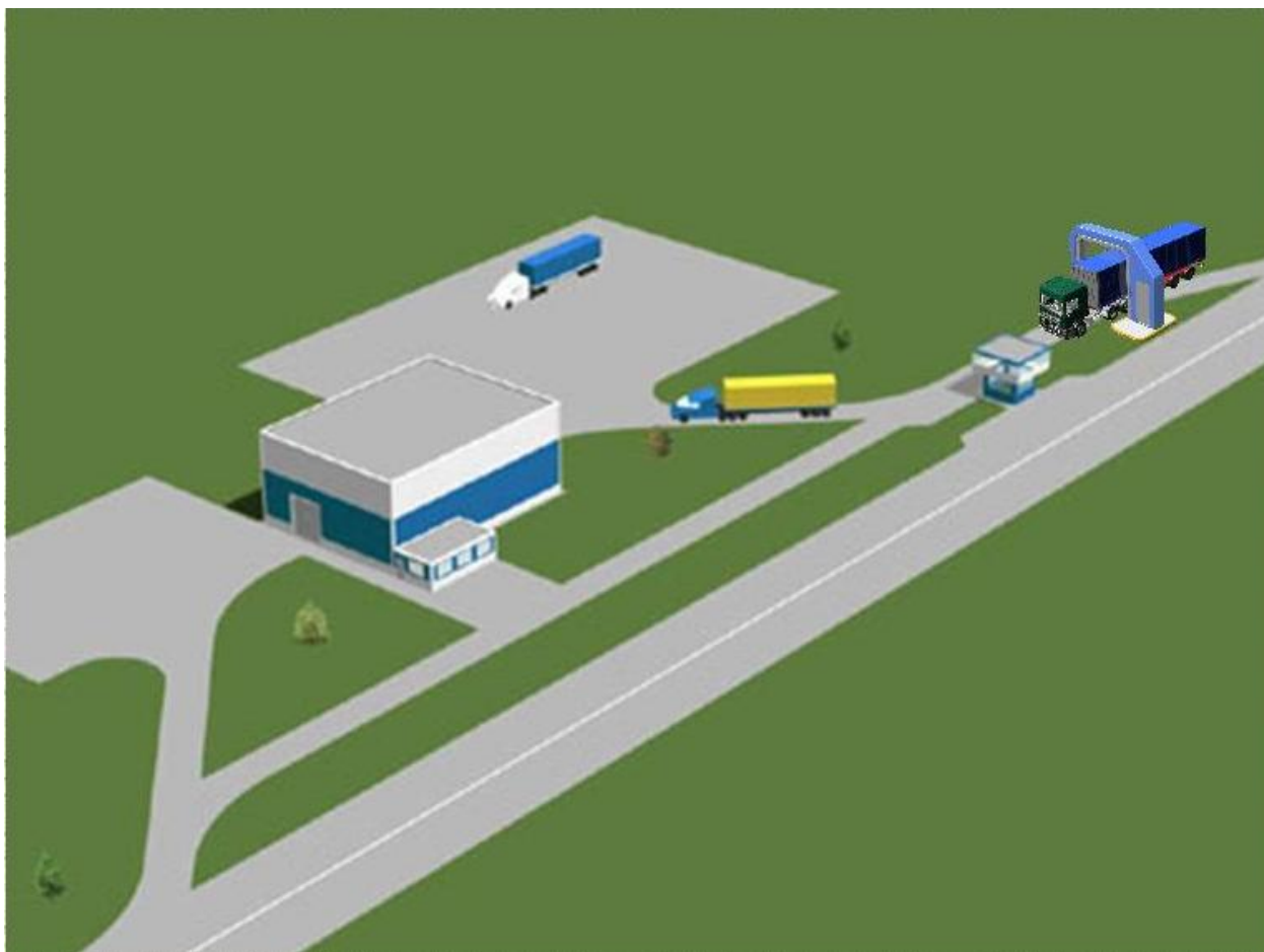
Рис. 4 Организация досмотра с использованием стационарного ИДК и высокопроизводительного комплекса портального типа
